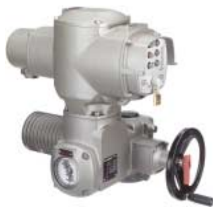
Unità di controllo AUMA Matic con attuatori multigiro SA/ SAR Coppie disponibili da 10 a 1 000 Nm Velocità disponibili da 4 a 180 min -1
