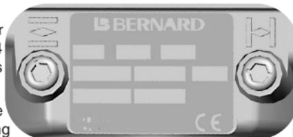
1 slag van de instelschroef = 4° van de instelhoek van de aandrijving.
